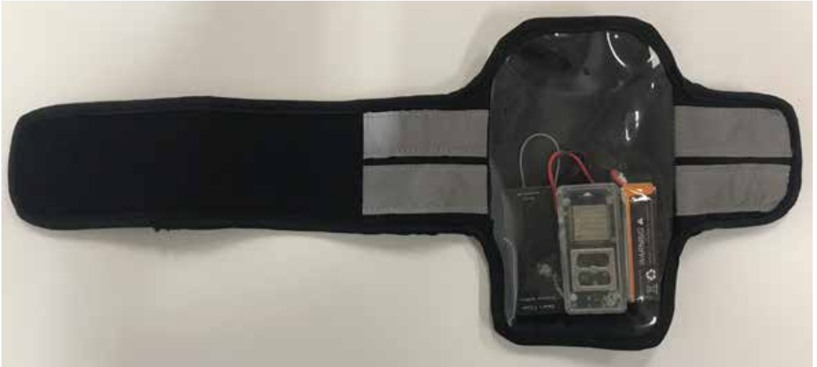
Figuur 2: De wearable met sensoren om de parameters te registreren.
