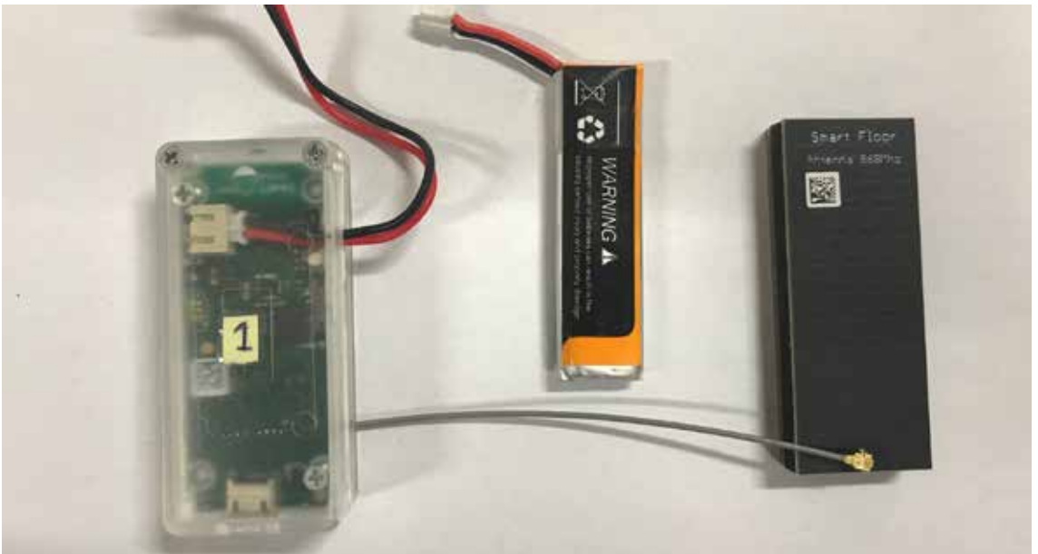
Figuur 3: De technische inhoud van de wearable waardoor de loopparameters worden gemeten. Van links naar rechts: de bewegingssensor en RFID-lezer, een batterij en een zwarte RFID-antenne.
